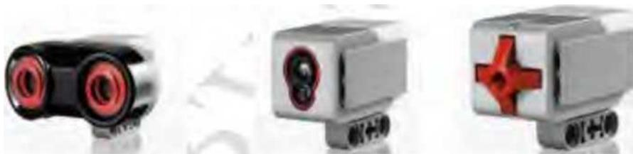
Датчик касания    Ультразвуковой датчик    Датчик цвета
